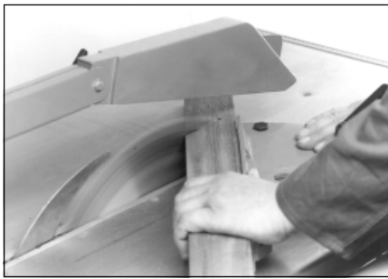
D Werkstück und Winkelanschlag nach vorne schieben
