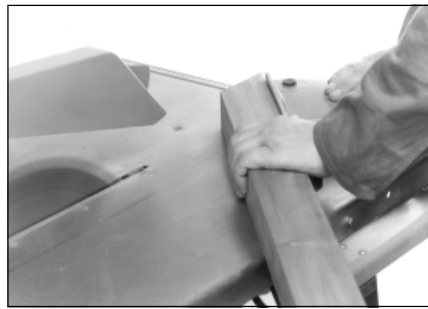
E Nach dem Abschnitt Werkstück und Winkelanschlag zurückziehen.
