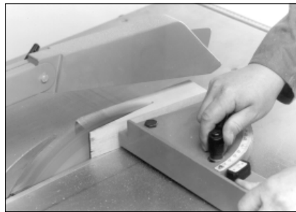
E Nach dem Abschnitt Werkstück und Winkelanschlag zurückziehen.
